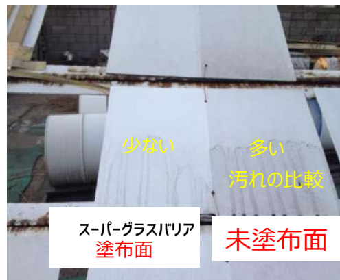
汚れにより赤外線反射率低下
