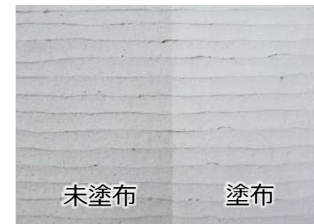
水系塗り壁材 ジョリパット コーティング後5年経過
